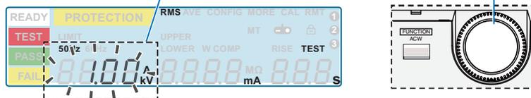
SHIFT キー押ししながらロータリーノブを回すと、値を設定する動作速度が変わります。SHIFT キーを押している間、高速で変化して値を設定できます。
