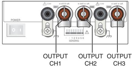
Fig. 4-6 PMP18-3TR/PMP25-2TR output terminals
