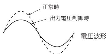
\*1. RMS 値を計算しています。計測処理時間と電圧分解能の関係で、電流リミット値を数秒間超える場合があります。制御中は、電流値が振動（増減）する場合があります。
