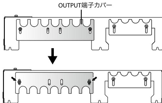
**7** 手順 3 ではずした端子カバーを、ねじ (5 か所) で取り付けます。
