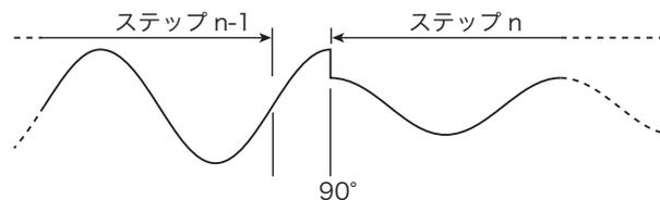
次に、位相急変するステップの開始位相角を  $270^\circ$  に設定します。1 つ前のステップのステップ時間が終了して  $90^\circ$  になっても、 $270^\circ$  になるまでステップは切り替わりません。
