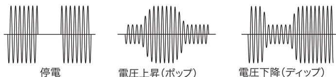
電源ライン異常シミュレーションでは、正弦波形が出力されます。波形バンクで特殊波形が設定されていても、電源ライン異常シミュレーションを実行すると正弦波形になります。
