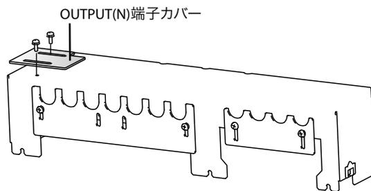
**6** OUTPUT 端子カバーのねじ (M3、2 か所) を外して、カバーの向きを変え、はずしたねじで取り付けます。
