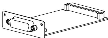
後面パネルのスロットにインターフェイスボードを装着します。
