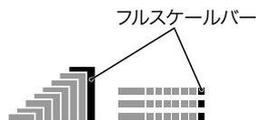
過負荷直前になると、本製品の内部温度が上昇するため、負荷を軽減してもフルスケールバーだけ薄い赤色で点灯し続ける場合があります。冷却が終了すると、フルスケールバーは消灯します。
