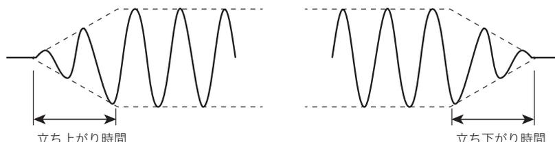
外部アナログ信号で制御する場合に、信号源が外部信号のみ（EXT）を使用しているときと、外部からの直流信号で電圧値を変更しているときは、ソフトスタート/ソフトストップの設定ができません。
