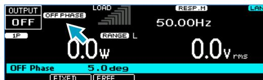
OFF PHASE (SHIFT+4) キーを押して出力オフ位相を設定します。
