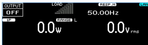
ホームポジションは最上位層です。各機能はさらに階層化されています。ホームポジションは、出力方法によって表示が異なります。上図は単相出力時の例です。
