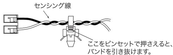
**6** 下図のように結束バンドの先端を本製品に取り付けます。
