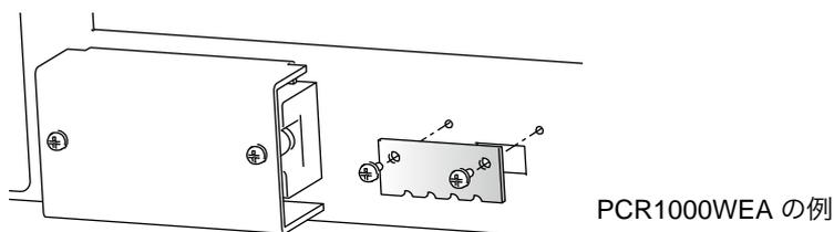
PCR-WEA2（PCR3000WEA2 を除く）の場合には、端子カバーのねじ（M4、5 か所）を外して、カバーを外します。
