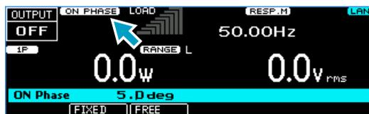
ON PHASE (SHIFT+7) キーを押して、出力オン位相を設定します。
