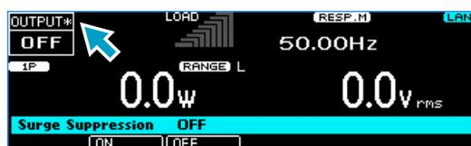
CONFIG (SHIFT+OPR MODE) > 1/3(F6) > SURGE S(F2) を押して、電圧サージ抑制を設定します。
