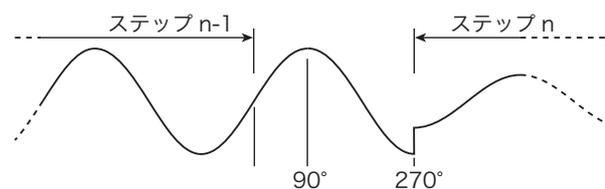
最後に、位相急変をオンに設定します。1 つ前のステップのステップ時間が終了して  $90^\circ$  になったときに次のステップに切り替わります。次のステップは  $270^\circ$  の状態から開始します。
