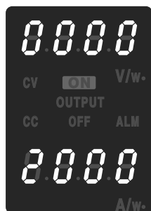
図 5-4 直列運転スレーブ機の設定例
