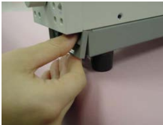
図 7-1 ルーバの取り外し
