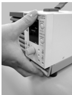
図 7-5 ルーバの取り外し
