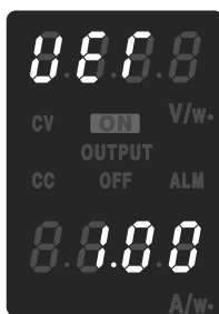
図 3-1 電源投入時のバージョン表示例
