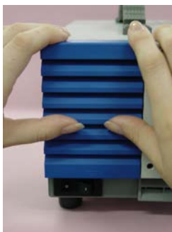
図 7-12 ルーバの取り付け
