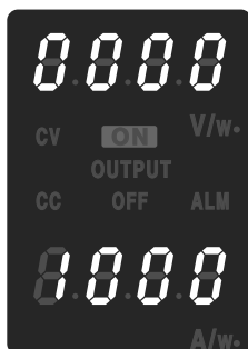
図 5-8 並列運転スレーブ機の設定例
