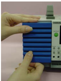
図 7-10ルーバの取り外し
