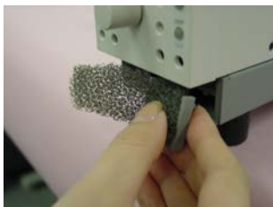
図 7-3 ルーバの取り付け
