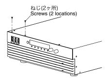
POWER スイッチ上部にある、カバーを取り 付けているねじを外します。
