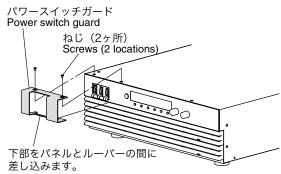
手順 1 で外したねじを使用して、パワース イッチガードを取り付けます。
