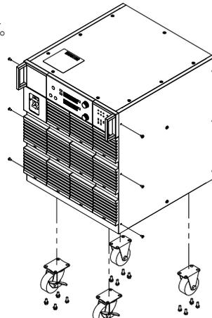
2. ④と⑤のねじを使用して①、②および③のブラケットを図のように取り付けます。
