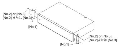
3. Using the accompanying screws and washers, mount the instrument in the rack. 付属しているねじ、ワッシャを使用してラックに取り付けます。
