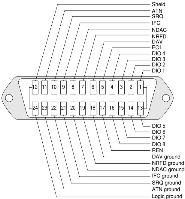
Fig. 4-3 GPIB Connector
